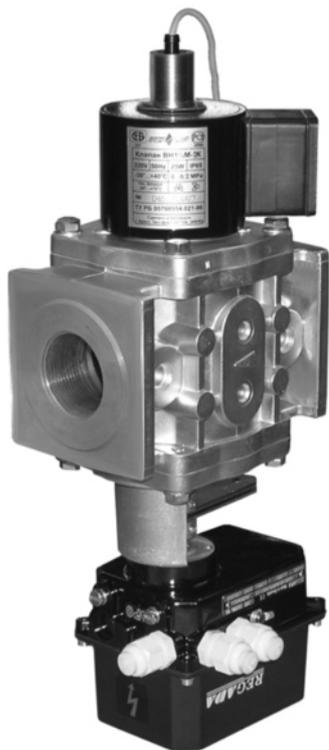
В конструкцию клапана встроена поворотная заслонка, при помощи которой осуществляется изменение количества пропускаемого газа через клапан. Конструктивно поворотная заслонка находится по ходу газа после запорного органа.
