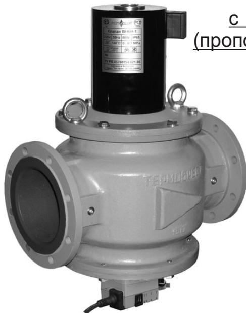
В конструкцию клапана встроена поворотная заслонка, при помощи которой осуществляется изменение количества пропускаемого газа через клапан. Конструктивно поворотная заслонка находится по ходу газа после запорного органа.
